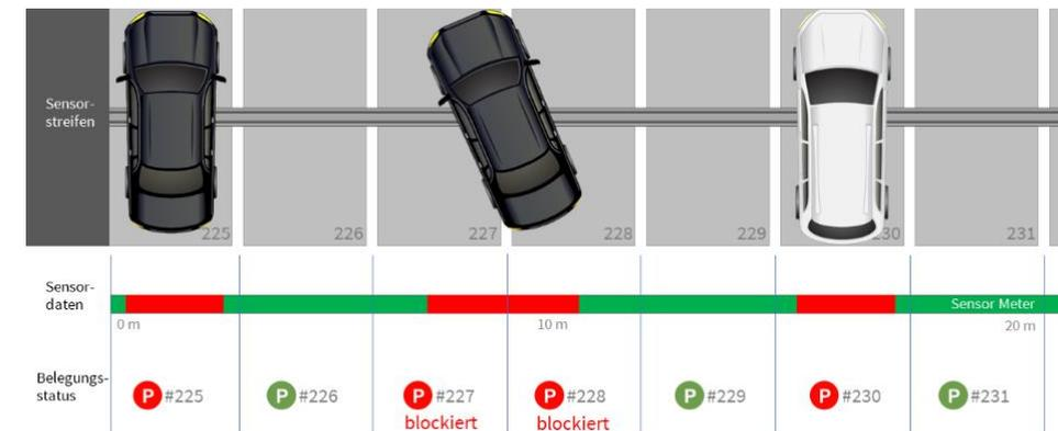
Abbildung 2: Detektion von geraden oder schief geparkten PKW
