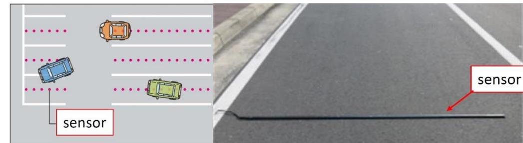
Abbildung 2: Über Boden verlegter Sensor auf Autobahn-Parkplatz in Japan [2]
