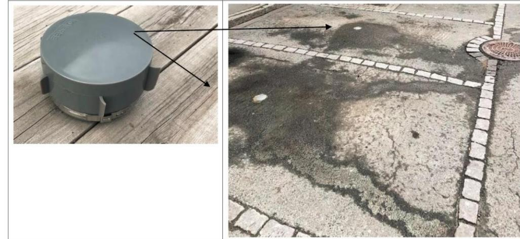
Abbildung 1: Unter Boden verlegter Sensor auf P&R-Parkplatz in Norwegen [1]
